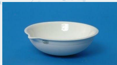
Cápsula de porcelana que soporta hasta 950°C
