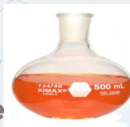
Matraz fondo redondo, boca reforzada con junta esmerilada Marca. Kimax.
