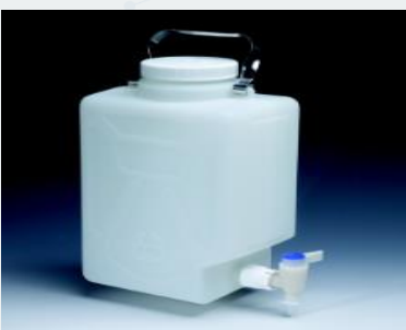
Garrafón de plástico rectangular con llave; HDPE fluorado, llave de ETFE Tefzel™, tapón de rosca de polipropileno blanco fluorado tapón de 10 cm. De diám. Nalgene™ DS2327
